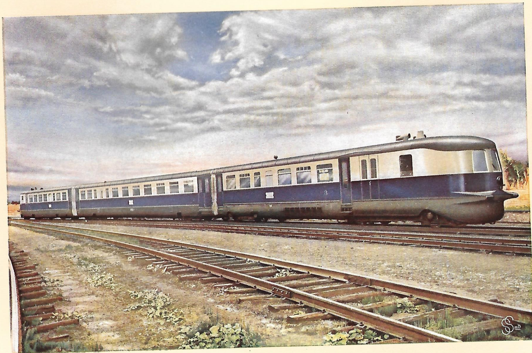
CAMINHOS DE FERRO NACIONAIS BELGAS : Carruagem-automotora Diesel articulada de 1.200 CV
